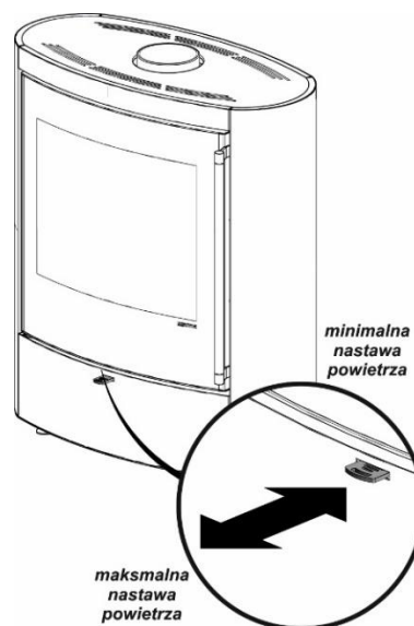
Rysunek 8. Ustawienie suwaka regulacji dopływu powietrza w pozycji maksymalnego otwarcia.
